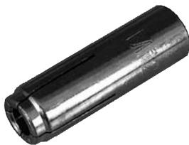
コーンを本体に内蔵することで、よりコンパクトに設計された「めねじタイプ」のアンカーです。アンカー打設時に、専用打込み棒の凸部が本体に完全に挿入されることにより打設完了の目安となり施工管理が容易にできる商品です。
